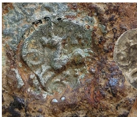
ABB. 11. Inhomogenität in Form eines schräg verlaufenden wurmartigen Wulstes auf der Patrize.
